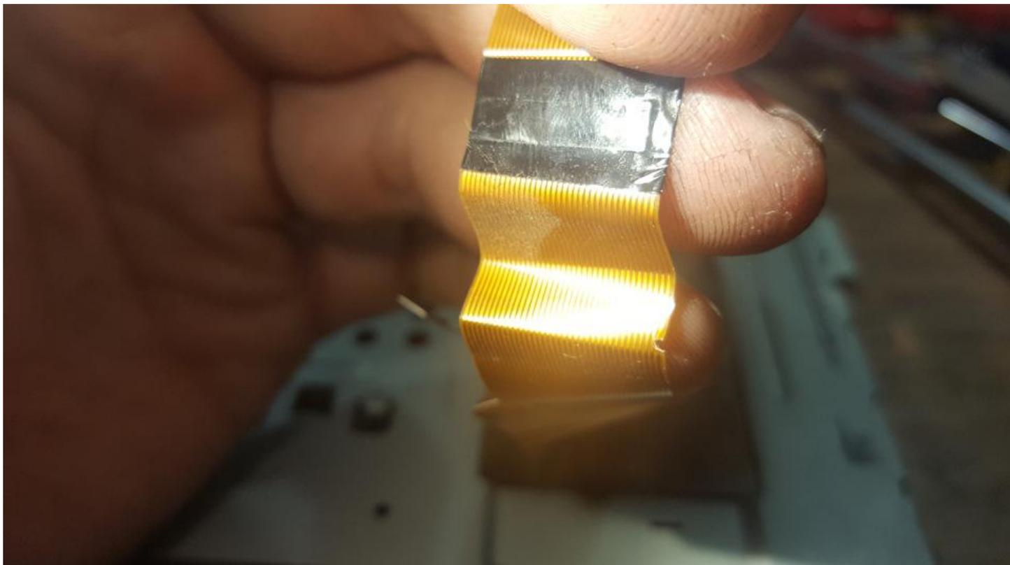
Для решения проблемы отрезаем шлейф в сантиметре от хвоста на сервопривод. Или еще проще, надо отмерить место, где шлейф неподвижен и максимально закреплен. Отрезаем обычным канцелярским ножом.
